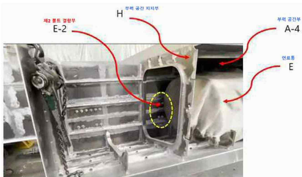
도 5. 확인대상발명의 일실시에 따른 수륙양용버스의 부력 공간부와 연료통을 촬영한 사진
