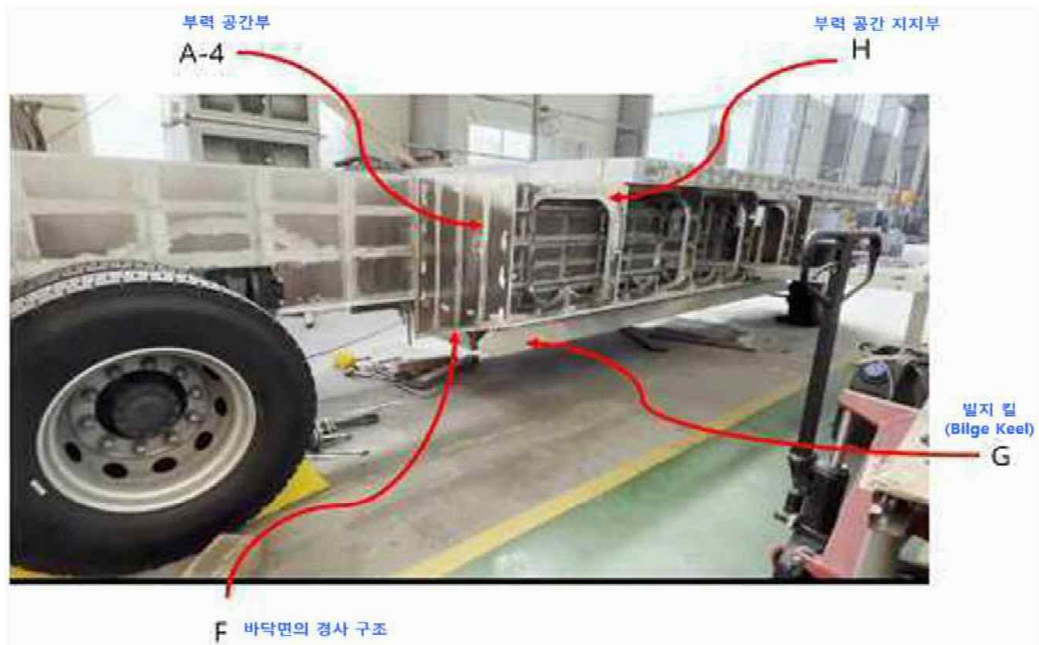
도 7. 확인대상발명의 일실시에 따른 수륙양용버스의 부력 공간부, 부력 공간 지지부, 관통홀, 밑지 킬의 배치를 촬영한 사진
